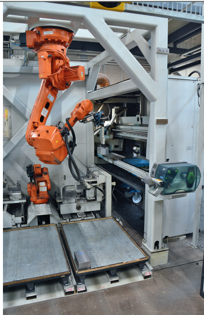
Produktiver Einstieg: Eine robotergeführte Hochleistungssäge mit automatischer Entgratung vom Typ Kasto Vario Speed sorgt für gratfreie Zuschnitte © Hanser
