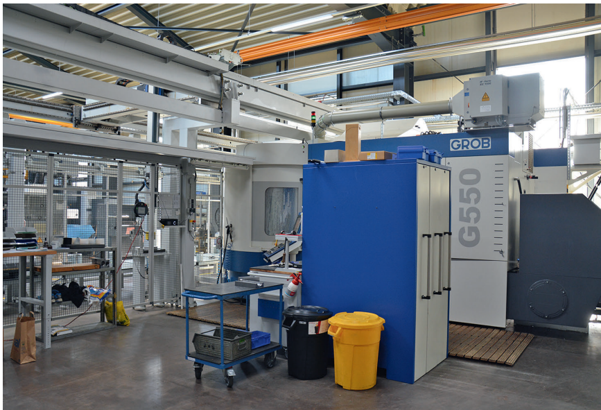
Komplettbearbeitung in der Fertigung: Ein 5-Achs-BAZ G550 von Grob mit Promot-Palettenautomation hat die Durchlaufzeit und die Kosten drastisch reduziert © Hanser
